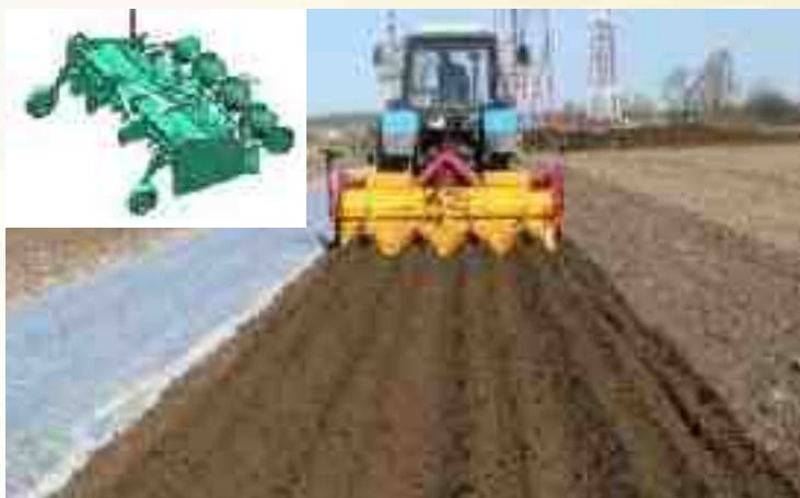
Образование узкопрофильных гряд с бороздами для посадки рассады ранней капусты
