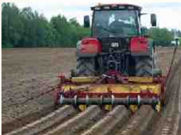
АПК 2,8 с профилеобразующим барабаном осуществляет формирование узкопрофильных гряд
