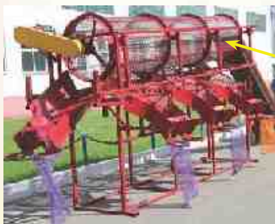
Установка обрезки луковиц перед посадкой для выращивания на перо
