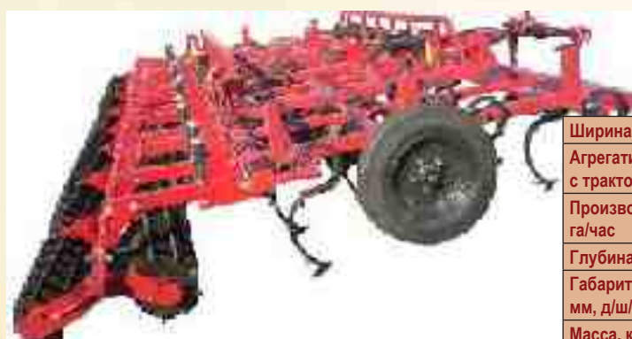
КУЛЬТИВАТОР ПРИЦЕПНОЙ КПМ-14/16
