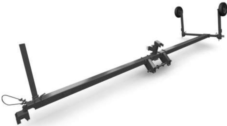
Рисунок 2 – Рама культиватора КХМ-6
