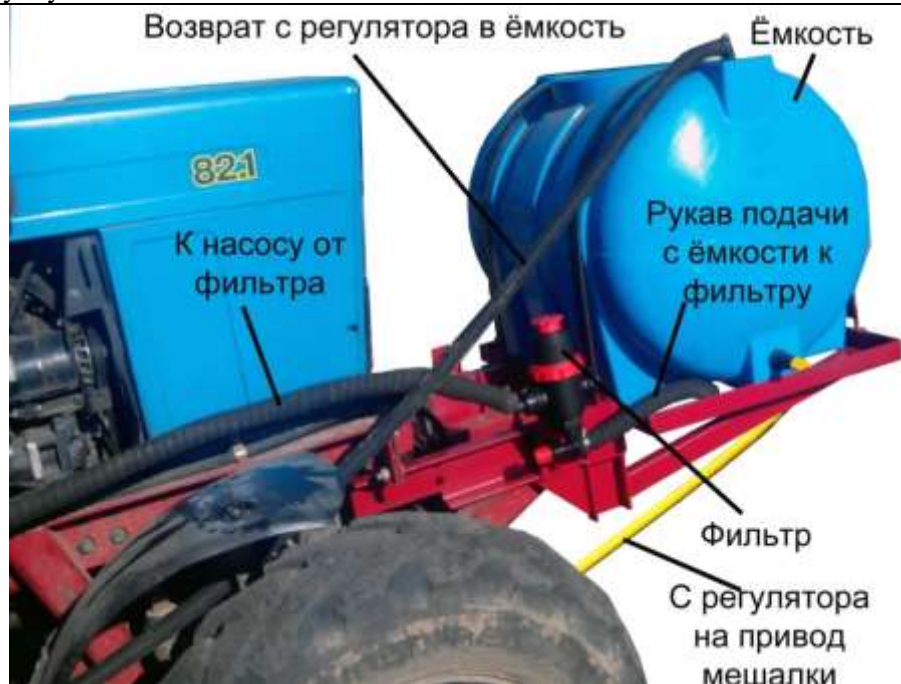
Рисунок 9 – Установка ёмкости и фильтра
