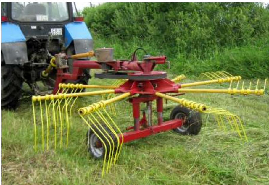
Рисунок 11 – Общий вид граблей-ворошилок роторных ГВР-3
