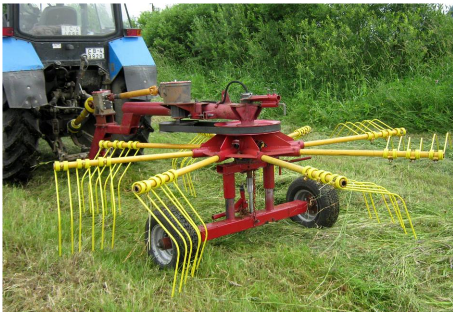
Рисунок 11 – Общий вид граблей-ворошилок роторных ГВР-3
