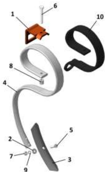
Рисунок 15 – КШЗ 00.050А Стойка с лапой
