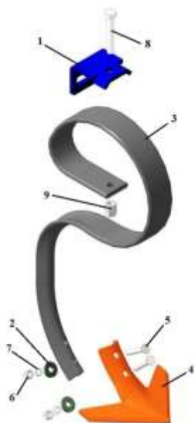
Рисунок 16 – КПМ 00.070 Стойка в сборе
