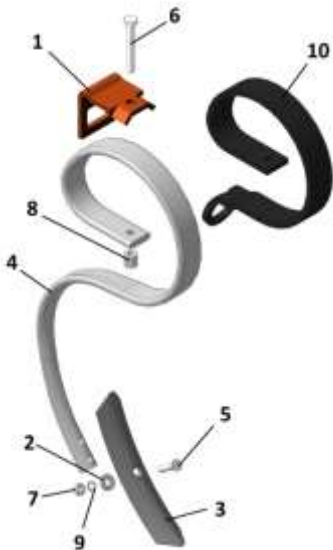
Рисунок 15 – КШЗ 00.050А Стойка с лапой
