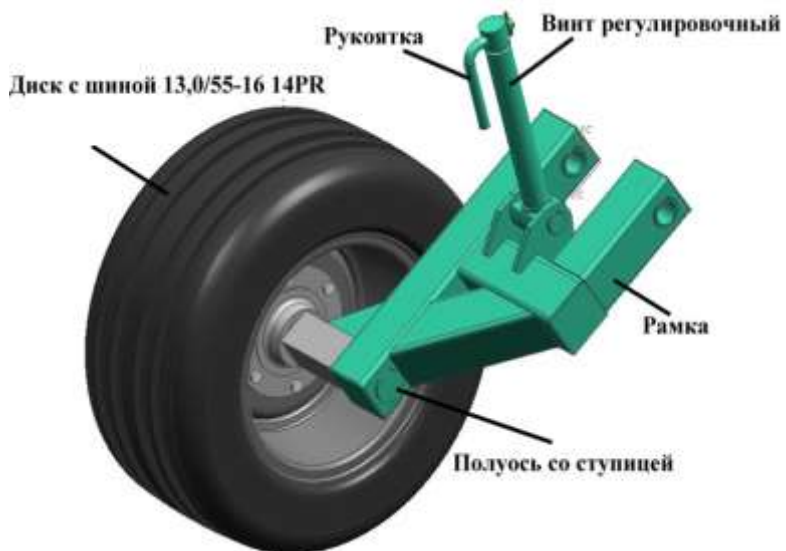
Рисунок 6 – Колесо копирующее и разворота
