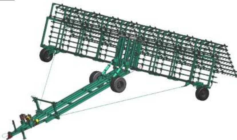
Рисунок 10 – Положение бороны при развороте
